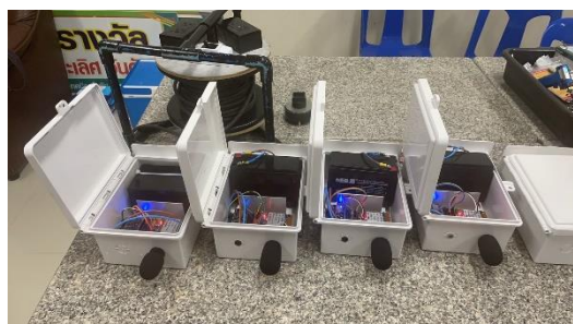
อุปกรณ์และการติดตั้งวัดระดับความดังของเสียง
